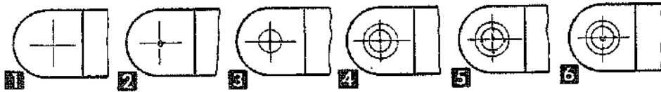
รูป B 96.1 วิธีขุดงานเพื่อเตรียมเจาะ (1) ขุดเส้นกึ่งกลาง (2) ให้เหล็กนำศูนย์ตอกนำศูนย์ที่จุดตัด (3) ขุดวงกลมรูเจาะ (4) เขียนวงกลมสอบรูเจาะ (5) สอบตำแหน่งรูเจ้านำศูนย์ด้วยจุดตอกบนวงกลมรูเจาะ (6) ตอกศูนย์ตำแหน่งจุดกึ่งกลางของรูเจาะใหม่อีกที
