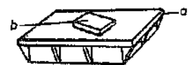
รูป B 134.5 วิธีสอบผิวด้วยการข้อมสี่ (a) แท่นผิวระดับ (b) ชั้นงาน
