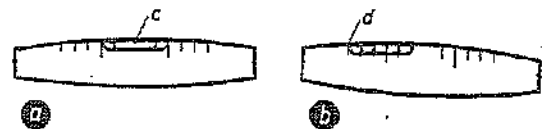
รูป B 155.3 หลอดแก้วระดับน้ำ (a) เมื่อวางราบได้ระดับ ฟองจะ อยู่ตรงกึ่งกลางพอดีที่ c (b) เมื่อวางไม่ราบฟอง จะเลื่อนไปอยู่ที่ d
