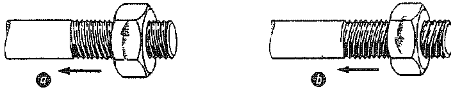
รูป B 185.1 ทิศทางการหมุนของเกลียว (a) เกลียวขวา (b) เกลียวซ้าย
