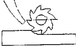
รูป B 132.1 (ขวา) งานกัดหยาบและละเอียด (a) ช่วงกัดลึกทั้งหมด (b) ช่วงกัดหยาบครั้งแรก ที่หนึ่ง (c) ช่วงกัดหยาบครั้งที่สอง (d) ช่วงกัดละเอียด (ลึก 0.5 - 1 มม.)
